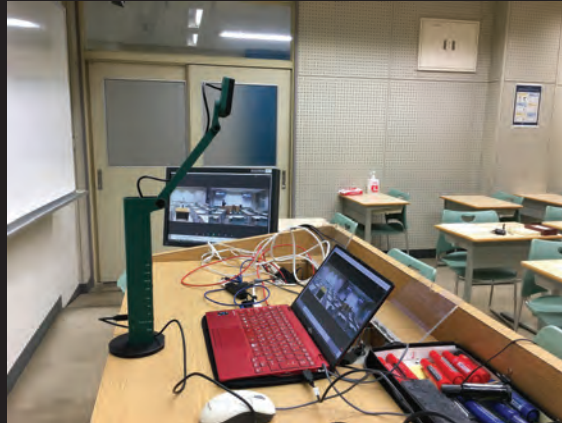
前方教卓上、教師から学生側を見る視点のWebカメラをZoomホストコンピュータにセット
